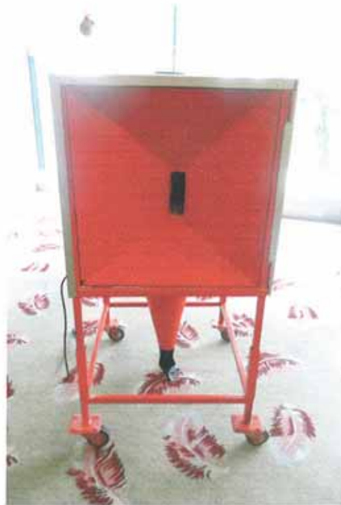
เครื่องดักฝุ่นกะลาเครื่องที่ 2 (ผลิตสำหรับกลุ่มคนพิการบ้านตะเคียนเตี้ย ชลบุรี)
