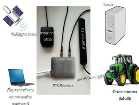
รูปที่ 3 การเชื่อมต่อการใช้งาน RTK Receiver board รุ่น PANTAI RB 1
