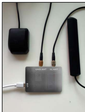
รูปที่ 1 เครื่องรับสัญญาณ GNSS รุ่น PANTAI RB1
