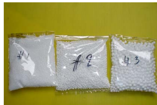
รูปที่ 1 เม็ดโฟมโพลีสไตรีนที่ใช้ในการวิจัย : (ซ้าย)- เม็ดโฟมขนาด 2 มิลลิเมตร (กลาง)-เม็ดโฟม ขนาด 4.75 มิลลิเมตร และ (ขวา)-เม็ดโฟม ขนาด 9.5 มิลลิเมตร
