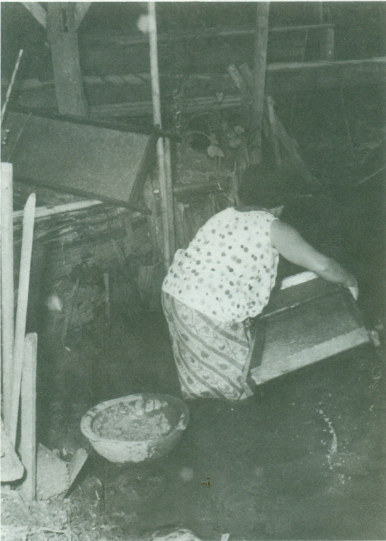
ยกพะแนงที่มีเยื่อข่อยขึ้นจากหน้า
