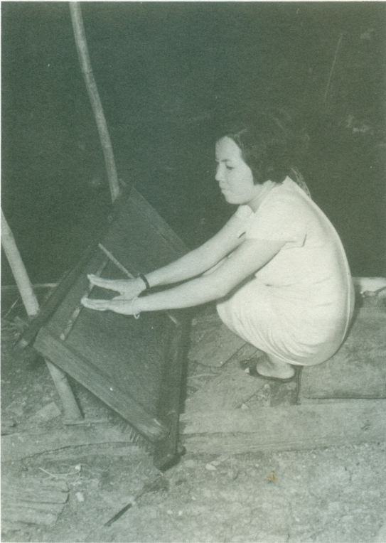
ใช้ไม้ซางคลึงรีดผิวน้ำเยื่อข่อยให้แห้งและเรียบ
