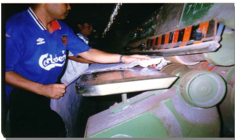
การเชิยรหนังเพื่อให้ขึ้นบางลงเพื่อนำไปขายส่งให้โรงงานแปรรูป
