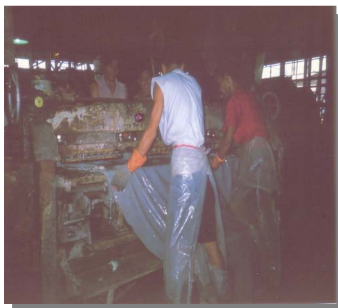
หนังเปียกที่คนงานนำเข้าเครื่องบีบน้ำ
