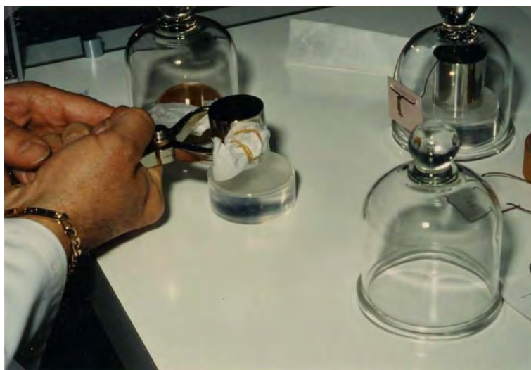
รูปที่ 34 ยกตุ้มนำมาวางพักบนฐานแก้วที่ทำด้วยฐานแท่งแก้ว Pyrex Disk หลังจากล้างเสร็จ
