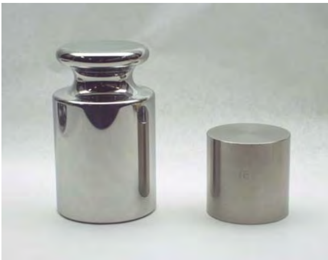
รูปที่ 8 เปรียบเทียบขนาดมวล 1 กิโลกรัมทำด้วย Stainless Steel (ทางซ้ายมือ) กับ มวล 1 กิโลกรัมทำด้วย Platinum (ทางขวามือ)
