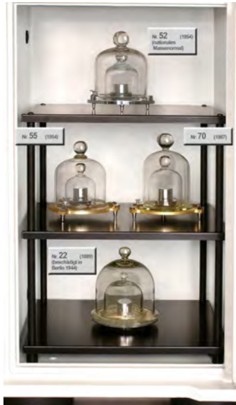
รูปที่ 12 แบบมาตรฐานมวลแห่งชาติของสหพันธ์สาธารณรัฐเยอรมนี Prototype No. 52 เก็บรักษาไว้ที่ PTB (Braunschweig)
