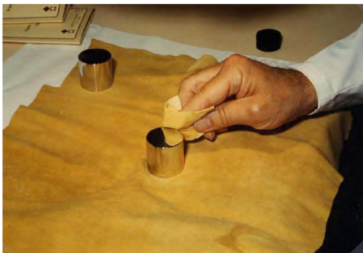
รูปที่ 26 ทำความสะอาดด้วยมือโดยใช้หนังชามัวร์ (Chamois) ซึ่งแช่ไว้ในสารละลายที่มีส่วนผสมเท่ากันระหว่าง Ethanol และ Ether เป็นเวลา 48 ชั่วโมง เริ่มต้นจากทำความสะอาดบริเวณฐานตุ้มน้ำหนัก
