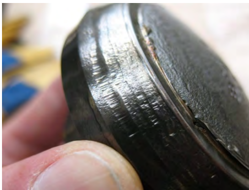
รูปที่ 3-21 ตัวอย่างการกัดกร่อนเชิงกลบนลิ้นวาล์วของ Globe Valve
