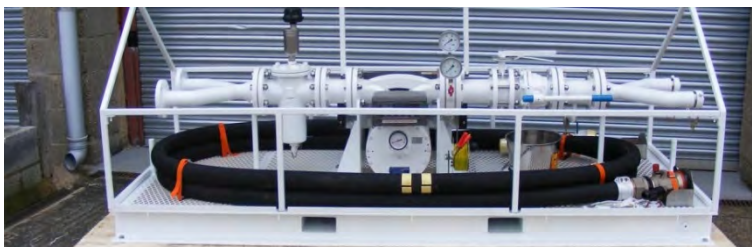
รูปที่ 2 องค์ประกอบที่สำคัญของระบบการวัดปริมาตรของเหลวแบบ Mobile
