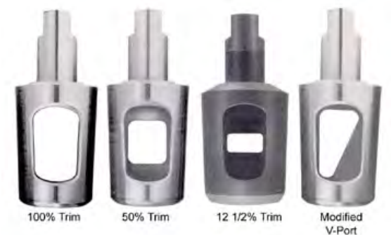
รูปที่ 3-66 รูปแบบของ Ports ชนิดต่างๆของ Plug Valve
