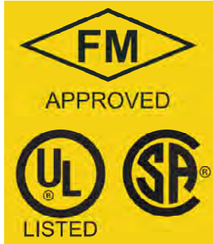
รูปที่ 19 เครื่องหมายของหน่วยงานรับรองอุปกรณ์ไฟฟ้าเพื่อใช้ในพื้นที่อันตราย ได้แก่ FM, UL และ CSA
