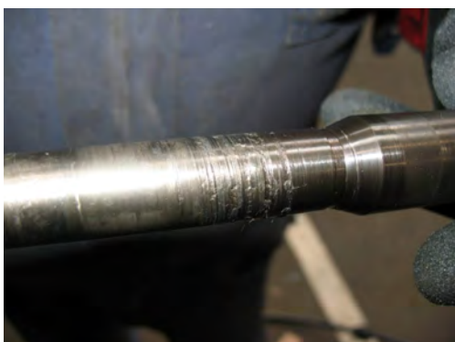
รูปที่ 3-22 ตัวอย่างการเกิด Galling บนก้านวาล์ว
