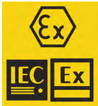
รูปที่ 20 เครื่องหมายของมาตรฐานอุปกรณ์ไฟฟ้าเพื่อใช้ในพื้นี่อันตรายตามมาตรฐาน ATEX และ IEC
