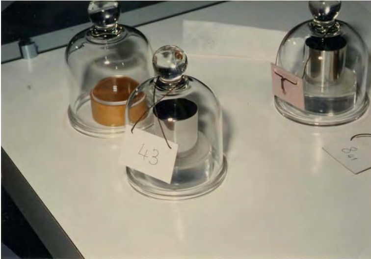
รูปที่ 35 เาฝาครอบแก้ว Bell Jar ครอบตุ้ม Prototypes ตลอดเวลา
