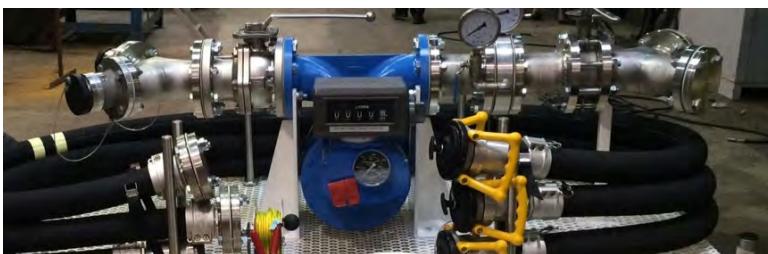
รูปที่ 3 มาตรวัดปริมาณของเหลวแบบ Mobile ที่ตัด Strainer ออกและไม่มีเครื่องกำจัดไอหรืออากาศ (Air/Gas Eliminator)
