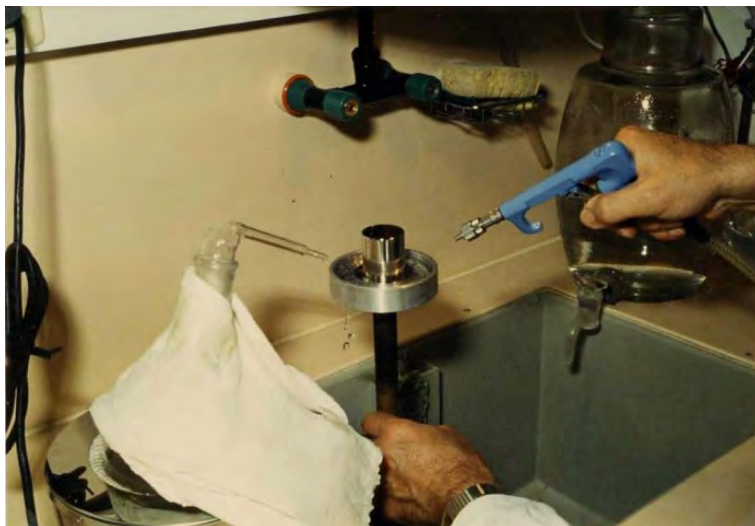
รูปที่ 33 ใช้ลมที่ผ่านการบำบัดคุณภาพอากาศอย่างดีเป่าไล่ความชื้นบริเวณผิวตุ้ม
