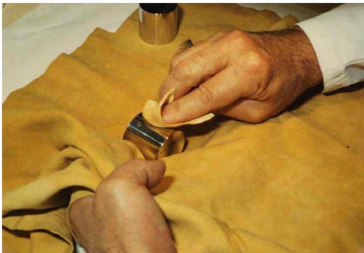
รูปที่ 27 ทำความสะอาดด้วยมือโดยใช้หนังชามัวร์ (Chamois) ซึ่งแช่ไว้ในสารละลายที่มีส่วนผสมเท่ากันระหว่าง Ethanol และ Ether เป็นเวลา 48 ชั่วโมง ทำความสะอาดบริเวณ Cylindrical Surface.
