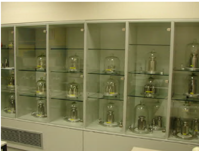
รูปที่ 13 แบบมาตรฐานมวลชั้น Primary standards 1 kg –10 kg ชั้นรองลงมา จาก “National Prototype” ของสหพันธ์สาธารณรัฐเยอรมนี
