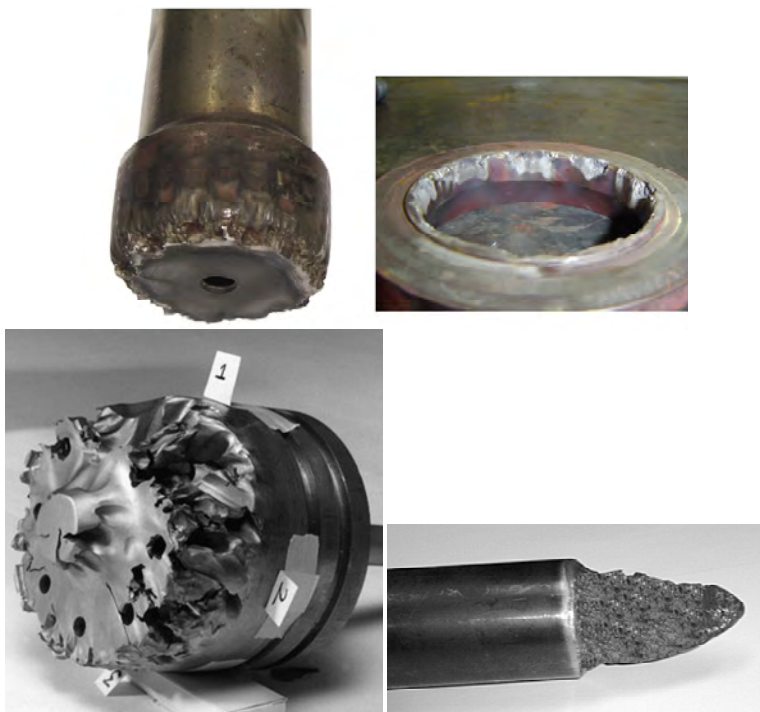
รูปที่ 4-46 Cavitation สร้างความเสียหายให้กับลิ้นวาล์วและ Seat Ring
