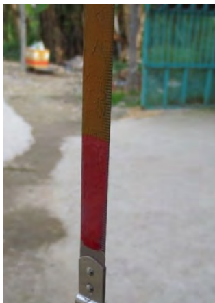
รูปที่ 10 รอยตัดของน้ำยาเปลี่ยนสีคือระยะรอยต่อระหว่างชั้นน้ำกับชั้นน้ำมัน
