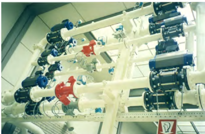
รูปที่ 7 มาตรวัดปริมาตรของเหลวชนิด Turbine Flow Meter ติดตั้งอยู่กับที่ (NMI Netherlands) พร้อมเครื่องวัดอุณหภูมิประจำมาตรวัดฯ
