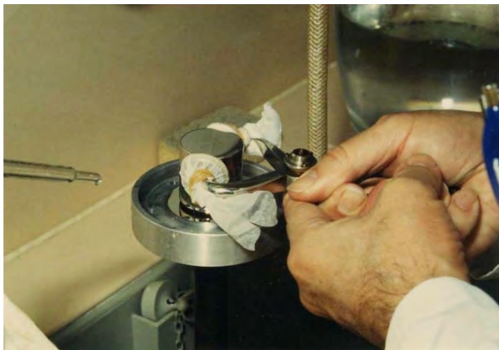
รูปที่ 29 ใช้คีมยกตุ้มน้ำหนักแบบมาตราโดยห่อหุ้มคีมด้วยชั้นในเป็นหนังชามัวร์ (Chamois) ส่วนชั้นนอกเป็น Lens Tissue ที่ใช้ทำความสะอาดเลนส์
