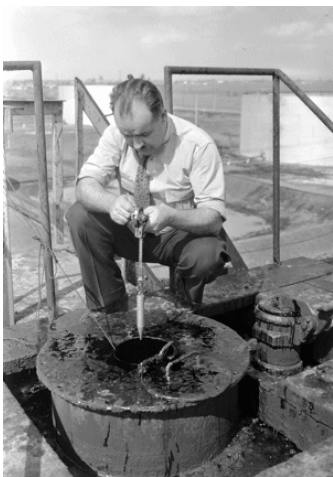
รูปที่ 8 วัดระดับของเหลวภายในถังสำรองด้วยมือโดยใช้ Sounding Tape
