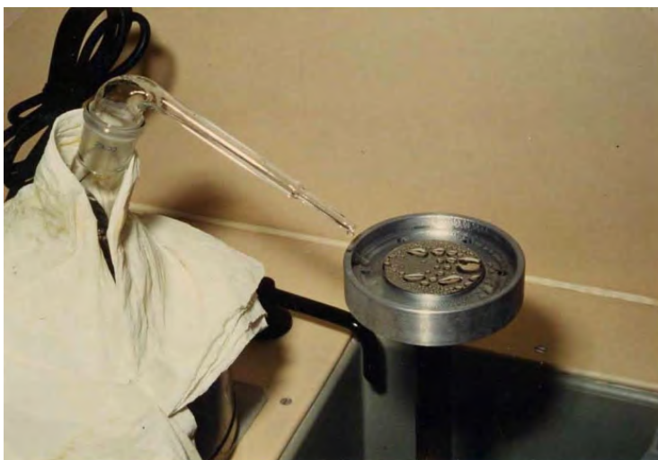
รูปที่ 28 ล้างฐานซึ่งวัดชุดทำด้วย Platinum-Iridium สำหรับวางตุ้มน้ำหนักแบบมาตรฐานด้วยไอน้ำ
