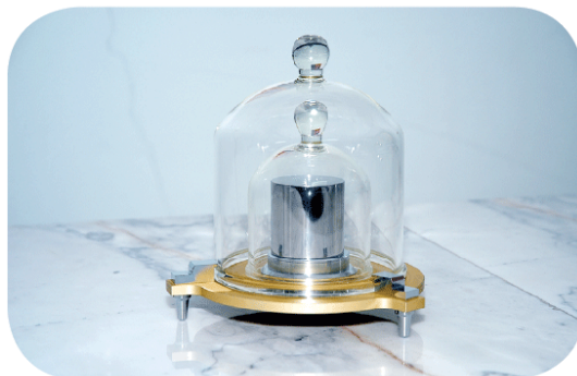
รูปที่ 16 มาตรฐานแห่งชาติด้านมวล 1 กิโลกรัมต้นแบบระหว่างประเทศ (International Prototype of the Kilogram) หมายเลข 80 ตามประกาศกระทรวงวิทยาศาสตร์และเทคโนโลยี
