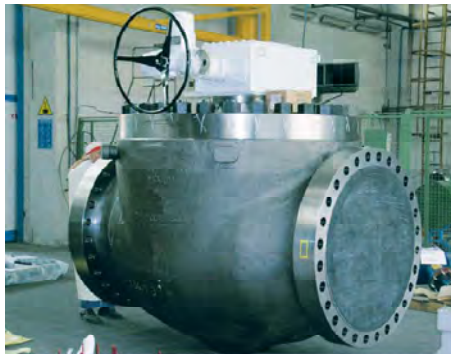
รูปที่ 3-39 Top Entry Design ของ Ball Valve
