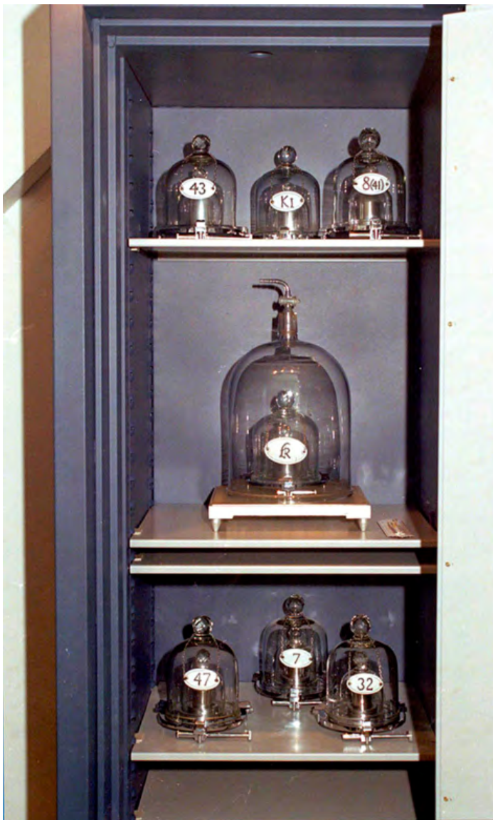
รูปที่ 10 การจัดเก็บ IKP ที่ BIPM ชั้นกลาง IKP หรือ Mr. R สำหรับ 6 Reference standard (tèmoins) แบ่งเก็บไว้ชั้นบน No.43, KI, No. 8(41) และชั้นล่างสุด No. 47, No. 7, No. 32
