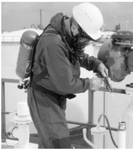
รูปที่ 8 วัดระดับของเหลวภายในถังสำรองด้วยมือโดยใช้ Sounding Tape
