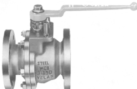
รูปที่ 3-37 Split Body Design ของ Ball Valve, ขนาด 3 นิ้ว, Class 150, วัสดุ ตัวเรือนวาล์วทำด้วยเหล็กหล่อเกรด WCB, ผู้ผลิต VELAN
