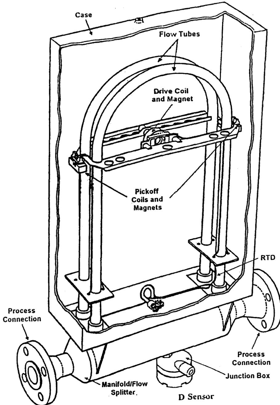
รูปที่ 9 หน่วยวัดของมาตรวัดมวลคอริโอลิส (coriolis mass flowmeter) Model "D" ของ Micro Motion, Inc.
