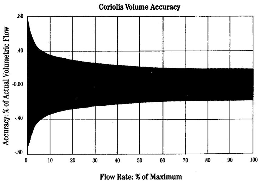
รูปที่ 41 ตัวอย่างการเปรียบเทียบกราฟแสดงสมรรถนะของมาตรวัดมวลคอริโอลิส (coriolis mass flowmeter) กับมาตรวัดชนิด Positive Displacement
