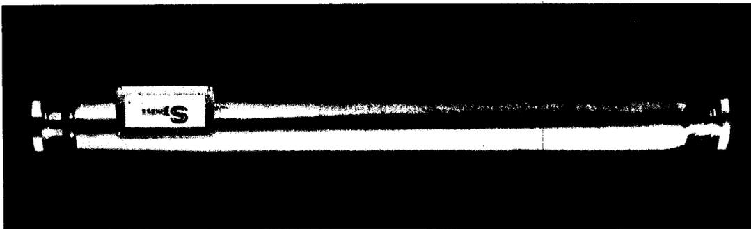
รูปที่ 6 ลักษณะทั่วไปของมาตรวัดมวลชนิด True Mass Flowmeter ของ Smith Meter Inc.
