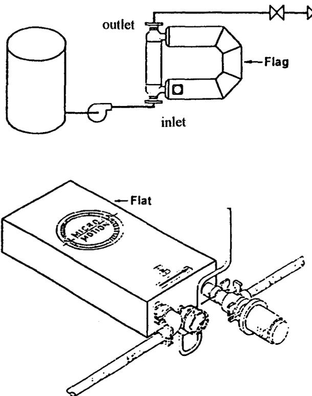
รูปที่ 47 ลักษณะการติดตั้งหน่วยวัดสำหรับใช้วัดอัตราการไหลมวลของของเหลวหรือก๊าซ ซึ่งต้องการท่อระบายออกจากหน่วยวัด (Tube Flat Position)
