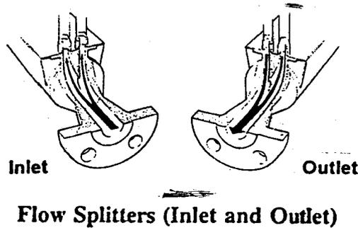
รูปที่ 12 ตัวแบ่งการไหล (flow Splitter)
