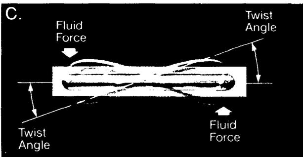
รูปที่ 30 ภาพถ่ายปรากฏการณ์การบิดตัวของท่อวัดอันเนื่องมาจากแรงคอริโอลิส (coriolis force)
