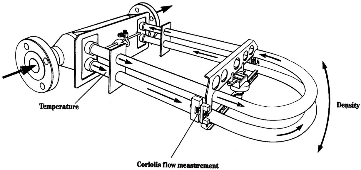
รูปที่ 35 การทำงานของหน่วยวัดเพื่อหาความหนาแน่นของเหลวที่ไหลผ่านท่อวัด
