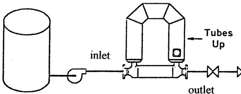
รูปที่ 45 ลักษณะการติดตั้งหน่วยวัดสำหรับใช้วัดอัตราการไหลมวลของก๊าซหรือทั้งสารแขวนลอย (Tube Up Position)
