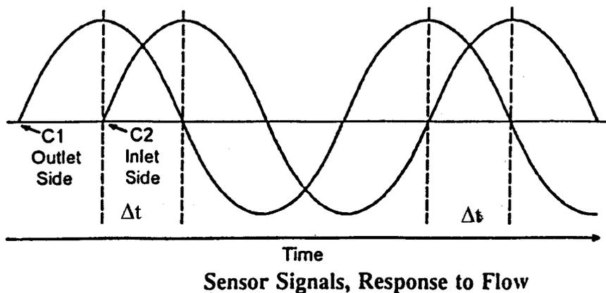
รูปที่ 33 สัญญาณซึ่งตรวจจับได้จากตัวตรวจจับการเคลื่อนที่ของการปิดตัวของท่อวัดเมื่อสภาวะมีการไหล
