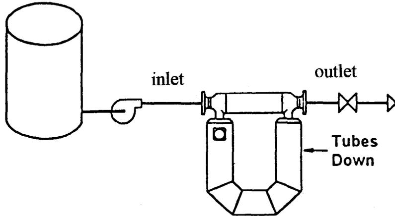
รูปที่ 46 ลักษณะการติดตั้งหน่วยวัดสำหรับใช้วัดอัตราการไหลมวลของของเหลว (Tube Down Position)
