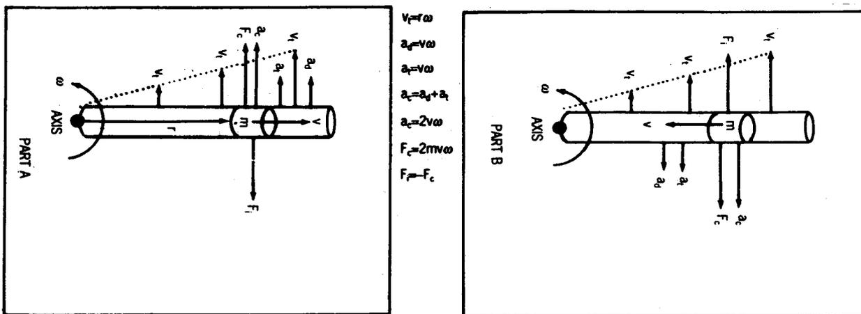
รูปที่ ข-2 แรงคอริออริสบริเวณท่อวัดขาเข้า รูปที่ ข-3 แรงคอริออริสบริเวณท่อวัดขาออก
