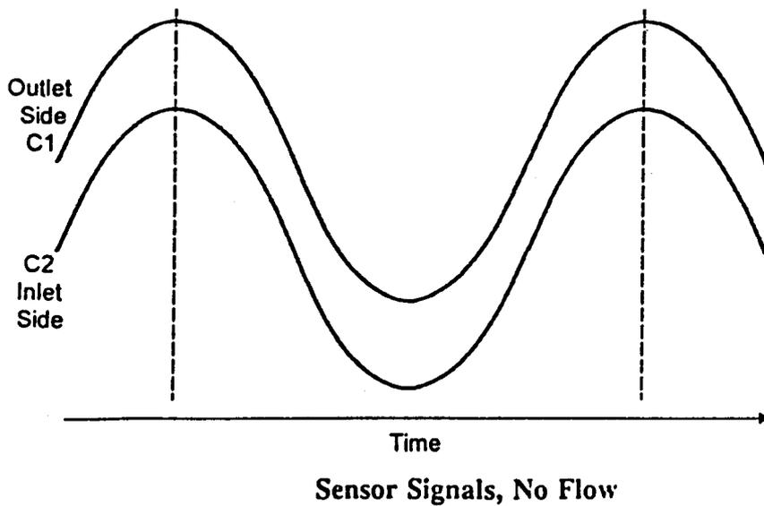
รูปที่ 32 สัญญาณซึ่งตรวจจับได้จากตัวตรวจจับการเคลื่อนที่ของการปิดตัวของท่อวัดเมื่อสภาวะไม่มีการไหล
