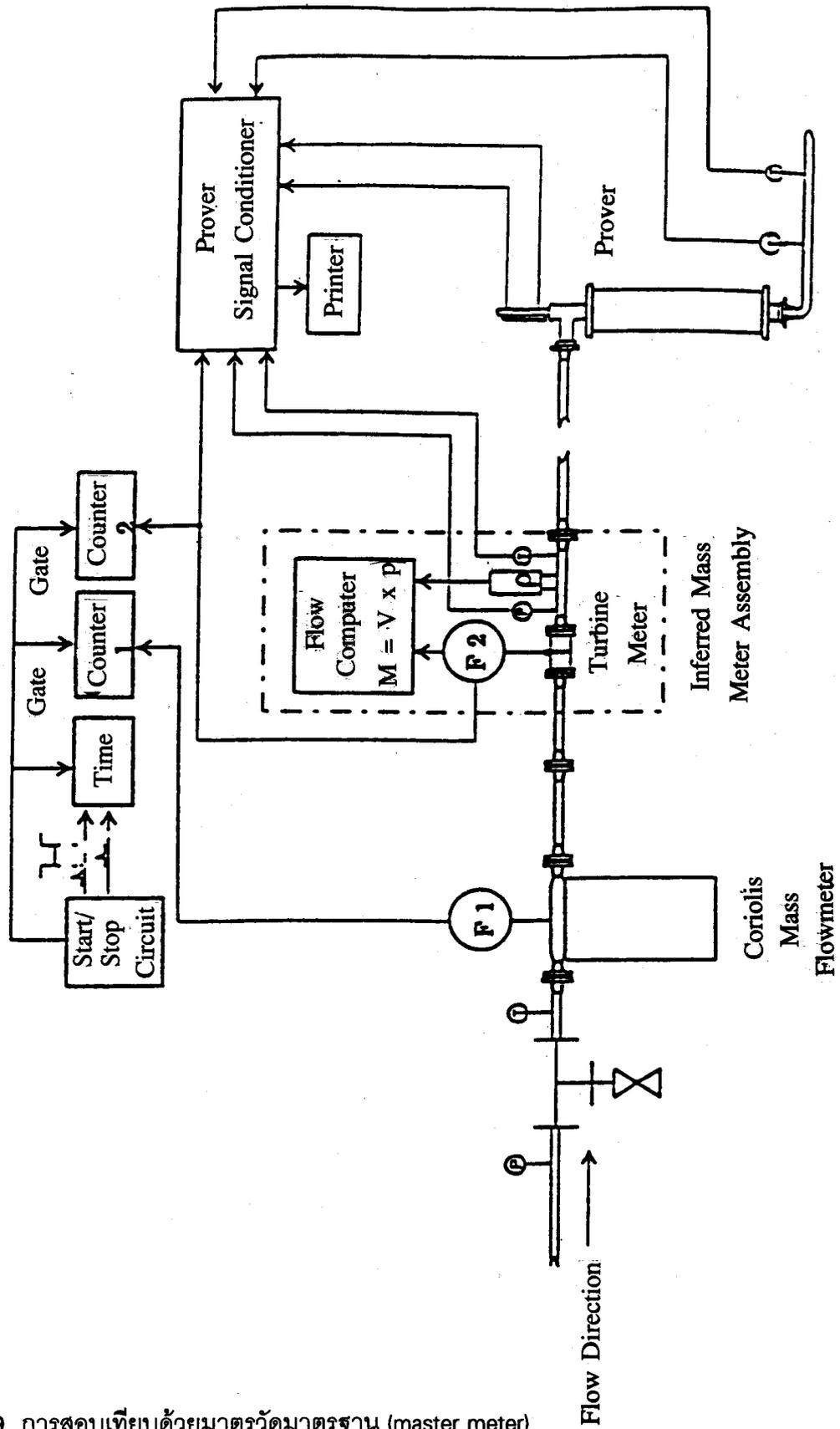
รูปที่ 59 การสอบเทียบด้วยมาตรวัดมาตรฐาน (master meter)
