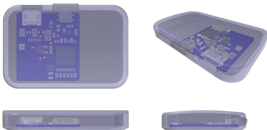
ภาพที่ 17 การออกแบบผลิตภัณฑ์ 3D เครื่องตรวจวิเคราะห์อาการสั่น
