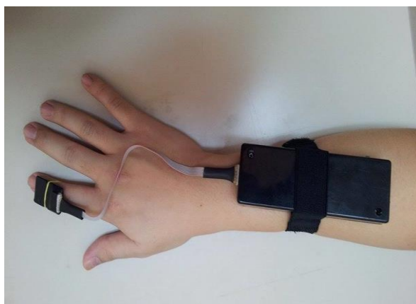
ภาพที่ 2 การพัฒนาเครื่องตรวจวิเคราะห์อาการสั่นวิเคราะห์ 6 แนวแกน accelerometer และ gyroscope
