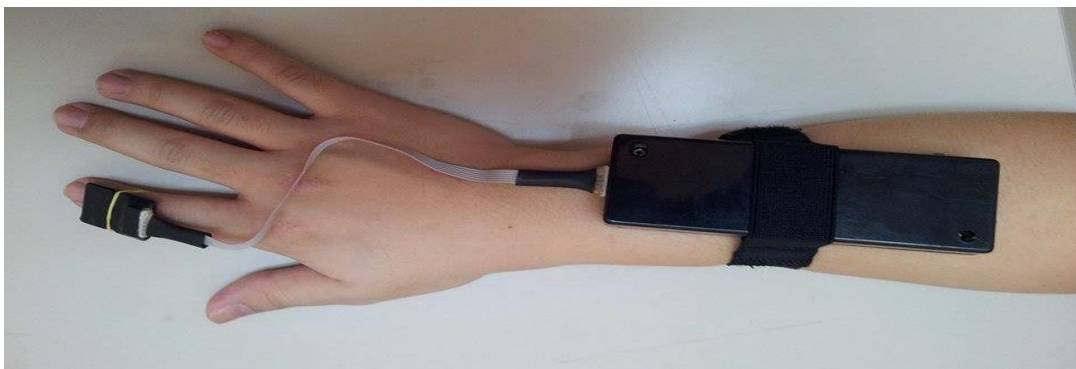
ภาพที่ 10 เครื่องตรวจวินิจฉัยอาการสั่นรุ่นที่ 1 แบบชั้นเดียว (pcb 1 layer)
