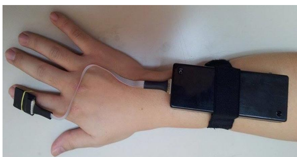
ภาพที่ 7 ตำแหน่งติดเครื่องวิเคราะห์ท่าการสั่น รุ่นแรก (ซ้าย) และเครื่องวิเคราะห์ท่าการสั่น รุ่นสอง (ซ้าย)
