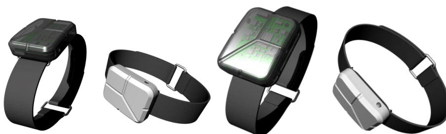
ภาพที่ 18 ลักษณะ 3D เครื่องตรวจวิเคราะห์อาการสั่น มีสายรัดข้อมือและสามารถ lock ได้
