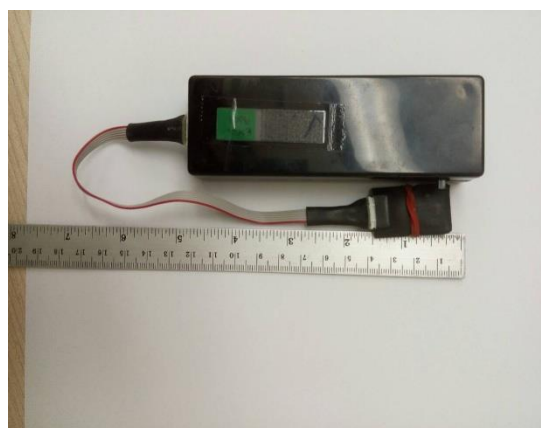
ภาพที่ 2 การพัฒนาเครื่องตรวจวิเคราะห์อาการสั่นวิเคราะห์ 6 แนวแกน accelerometer และ gyroscope
