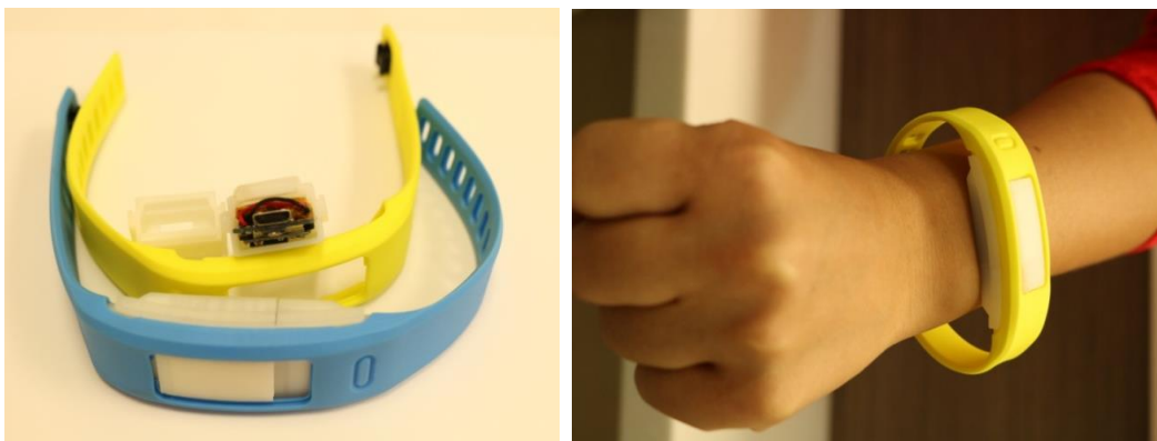
ภาพที่ 11 เครื่องตรวจวินิจฉัยอาการสั่นร่นที่ 2 แบบ 2 ชั้นซ้อนกัน (pcb 1 layer)
