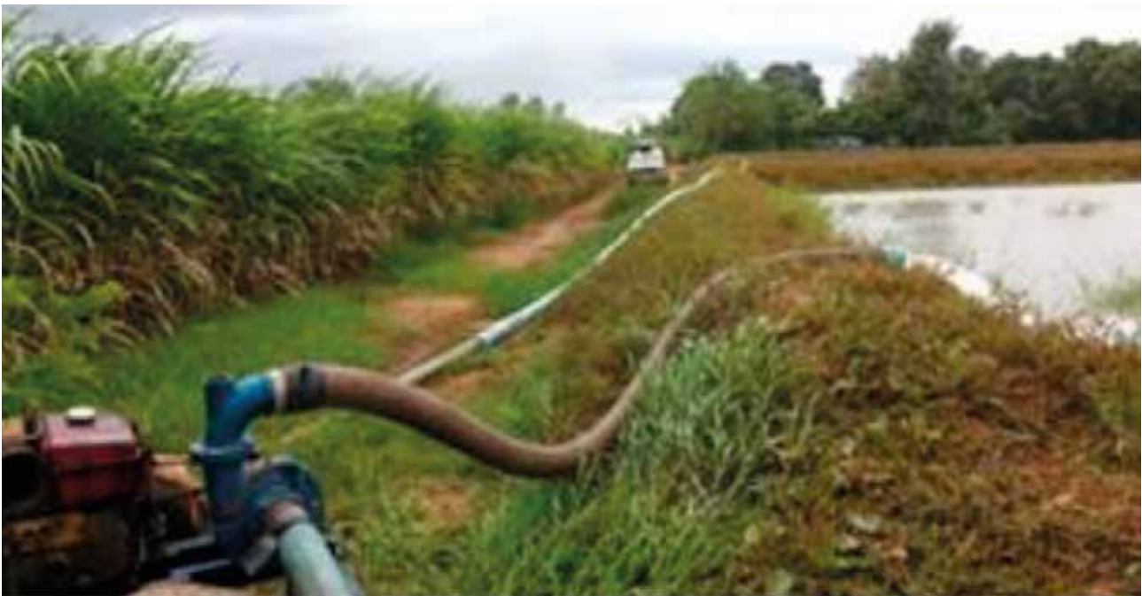
ภาพที่ 6 การใช้น้ำมันไฟโรไลซิสกับเครื่องยนต์ ที่มา : สถาบันวิจัยพลังงาน (2557)
