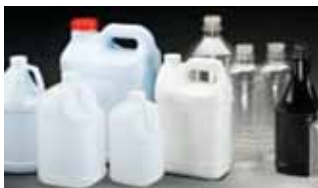
พอลิเอทิลีน (Polyethylene: PE) แบ่งเป็น HDPE และ LDPE
