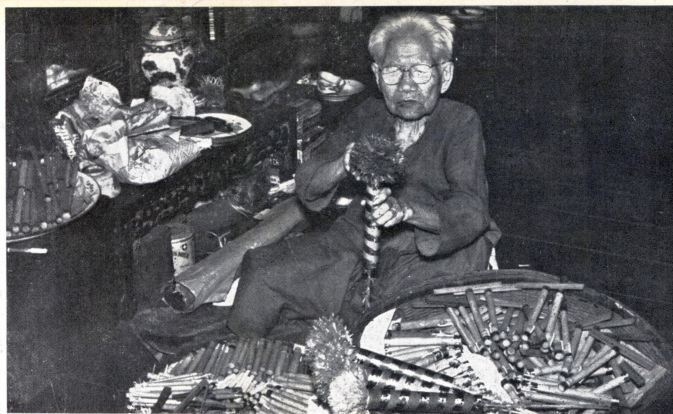
▲ การทำดอกไม้ตาด ผู้ทำกำลังปิดปากกรวยด้วยฝอยกระดาษ หลังจากบรรจุดิน (กำมะถัน ดินประสิว และถ่าน) แล้ว
