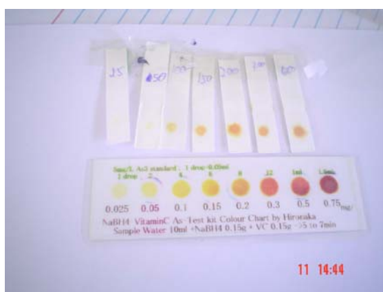
การเปรียบเทียบ Color chart จากการวิเคราะห์ กับ Standard color chart ของ AAN kit
