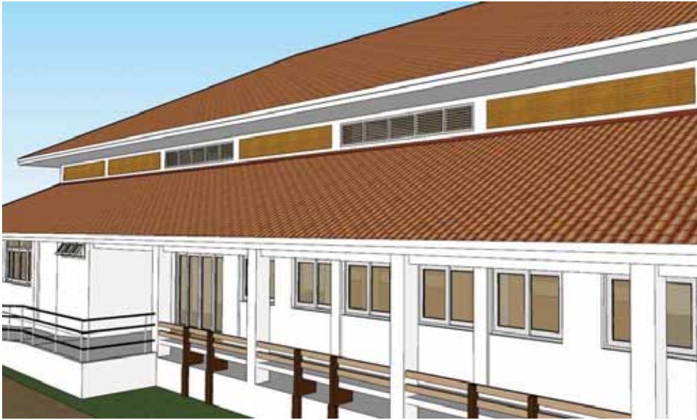
รูปที่ 5.110 ช่องแสงบานเกล็ดติดตายบริเวณผนังระหว่างหลังคาซ้อน
