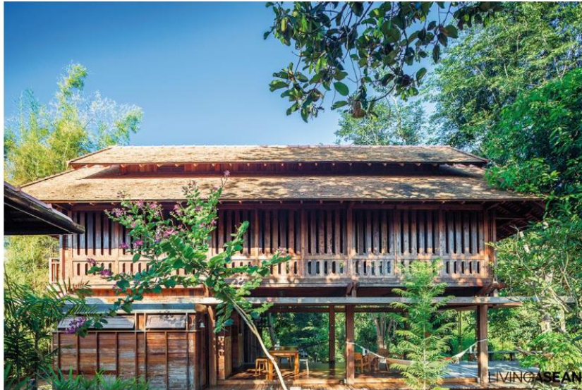
รูปที่ 6-41 ในเขตอากาศร้อนชื้นที่อุณหภูมิไม่สูงมากจะออกแบบให้ลมผ่านในระดับที่สัมผัสร่างกายโดยตรง (ที่มา: https://livingasean.com/tag/vernacular-house/ )
