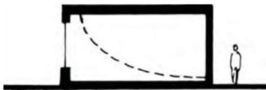
รูปที่ 10-24 กรณีไม่มี Light Shelf ความสว่างที่ริมหน้าต่างและด้านในจะแตกต่างกันมาก (ที่มา: Lechner, 2015)
