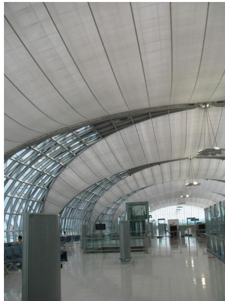
รูปที่ 5-21 อาคารสนามบินสุวรรณภูมิ ออกแบบให้อุณหภูมิที่พื้นต่ำกว่าอากาศ
