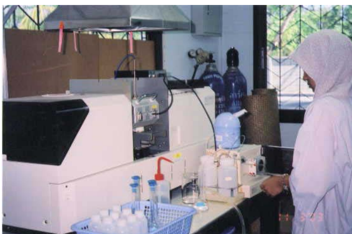
รูป 12 : เครื่อง AAS ใช้ตรวจสอบสารหนู
