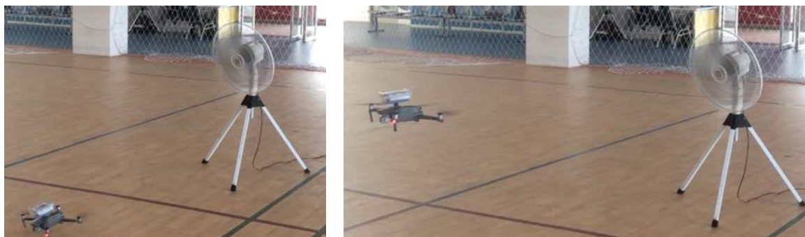
ภาพที่ 5 ระบบเซนเซอร์อากาศติดโดรนที่ผ่านการทดสอบการบินขึ้นลงแม้จะมีลมรบกวน ที่มา : ศรินทร์ นิตินาวรัตน์ ถ่ายเมื่อ พฤษภาคม 2563
