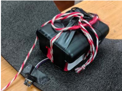
ภาพที่ 1 การติดเซนเซอร์อากาศเข้ากับปลูณและปล่อยขึ้นไปในชั้นบรรยากาศ ที่มา : ศิริินทร์ นิตินาวรัตน์ ถ่ายเมื่อ กันยายน 2562
