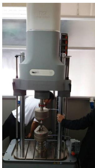
รูปที่ 3.19 เครื่องทดสอบและประเมินสมบัติทางด้านความล้าข้อเข้าเทียมตามมาตรฐาน ISO 14879 ณ
