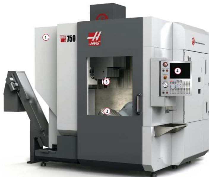
รูปที่ 3.46 เครื่องกัด 5 แกน HAAS รุ่น UMC 750
