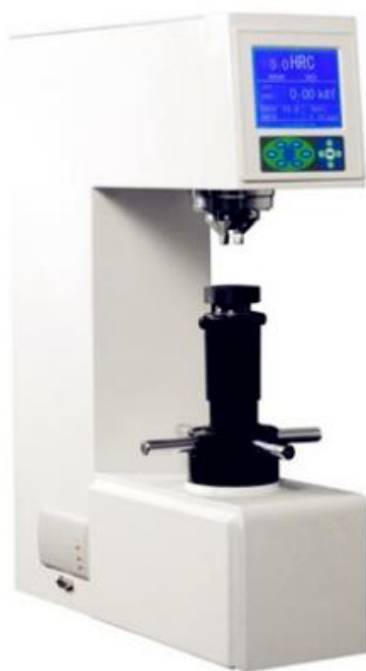
รูปที่ 3.52 เครื่องวัดความแข็งวัสดุแบบ Rockwell โดยมีขั้นตอนการใช้งานเครื่องวัดความแข็งดังนี้
