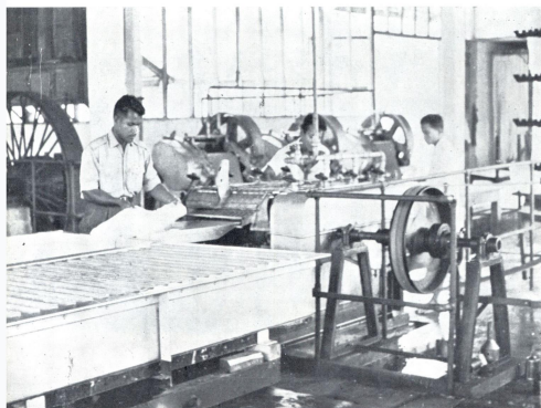
▲ น้ำยางที่ผสมด้วยขี้เถ้าและปูนเป็นเนื้อ น้ําเข้าเครื่องรีด Rubber lumps are put in the pressing machine for making rubber sheets.
