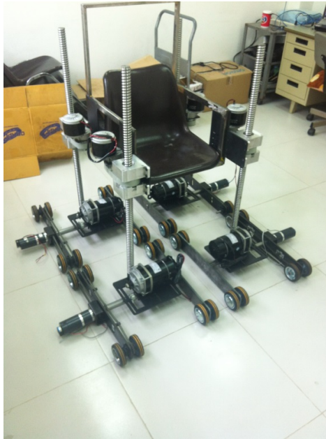
รูปที่ 4.4 ภาพถ่ายของเก้าอี้หุ่นยนต์เคลื่อนที่ขึ้นลงพื้นต่างระดับอัตโนมัติ เวอร์ชันแรกที่มี 12 องศาความมีอิสระ
