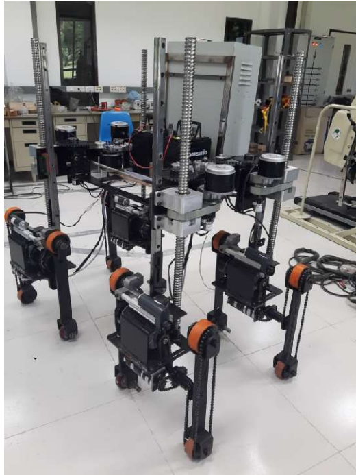
รูปที่ 4.5 ภาพถ่ายของเก้าอี้หุ่นยนต์เคลื่อนที่ขึ้นลงพื้นต่างระดับอัตโนมัติ เวอร์ชันสุดท้ายที่มี 16 องศาความมีอิสระเคลื่อนที่เป็นเส้นตรง
