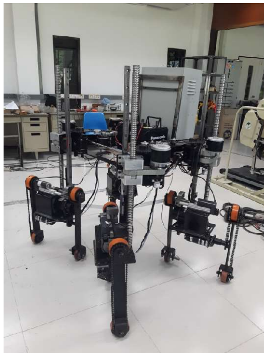
รูปที่ 4.6 ภาพถ่ายของเก้าอี้หุ่นยนต์เคลื่อนที่ขึ้นลงพื้นต่างระดับอัตโนมัติ เวอร์ชันสุดท้ายที่มี 16 องศาความมีอิสระเคลื่อนที่เลี้ยว
