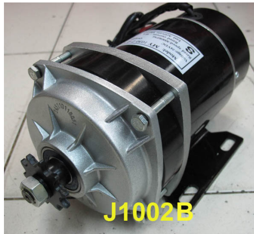
รูปที่ 5.1 มอเตอร์ไฟฟ้ากระแสตรงขนาด 750 วัตต์
