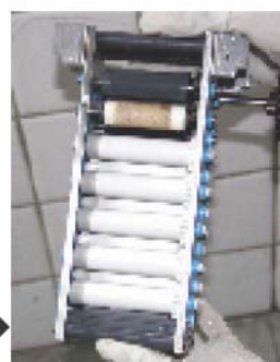
ตำแหน่งที่ฝุ่นละอองมักจะติดเข้าภายในเครื่องทำสำเนาไมโครฟิล์มเนื่องจากไฟฟ้าสถิต ระหว่างที่ไมโครฟิล์มหมุนไปขณะทำสำเนา
