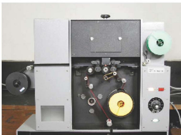
ภายนอกและภายในเครื่องสำหรับทำสำเนาไมโครฟิล์มชนิด Silver Halide แบบฟิล์มประกบฟิล์ม (Continuous Optical Silver Duplicator)
