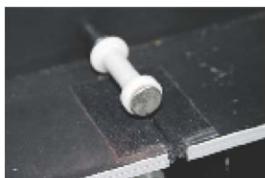
ตำแหน่งที่ฝุ่นละอองมักจะติดเข้าภายในเครื่องทำสำเนาไมโครฟิล์มเนื่องจากไฟฟ้าสถิต ระหว่างที่ไมโครฟิล์มหมุนไปขณะทำสำเนา
