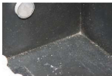
ตำแหน่งที่ฝุ่นละอองมักจะติดเข้าภายในเครื่องทำสำเนาไมโครฟิล์มเนื่องจากไฟฟ้าสถิต ระหว่างที่ไมโครฟิล์มหมุนไปขณะทำสำเนา
