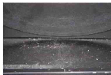
ตำแหน่งที่ฝุ่นละอองมักจะติดเข้าภายในเครื่องทำสำเนาไมโครฟิล์มเนื่องจากไฟฟ้าสถิต ระหว่างที่ไมโครฟิล์มหมุนไปขณะทำสำเนา
