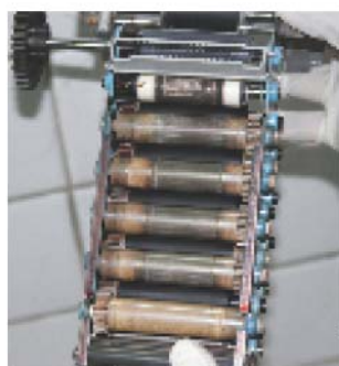
ตำแหน่งที่ฝุ่นละอองมักจะติดเข้าภายในเครื่องทำสำเนาไมโครฟิล์มเนื่องจากไฟฟ้าสถิต ระหว่างที่ไมโครฟิล์มหมุนไปขณะทำสำเนา
