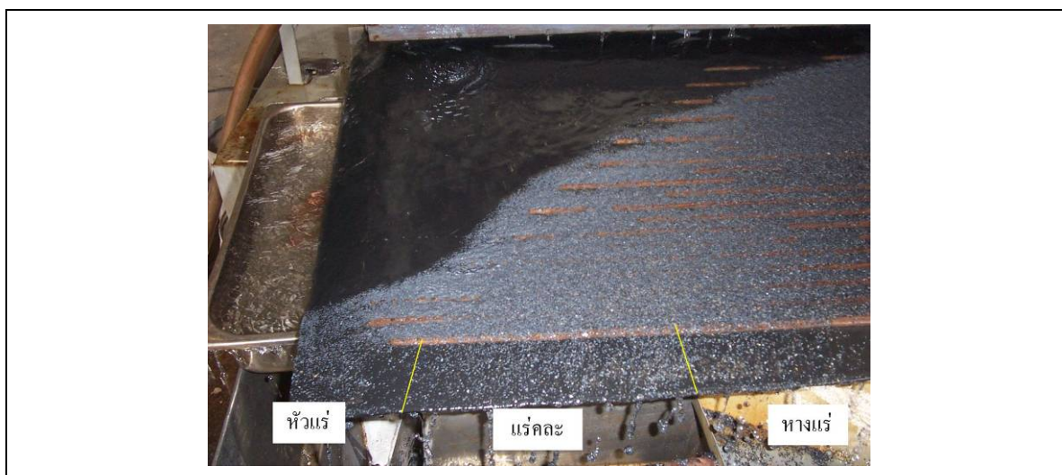
รูป 3.7 ภาพแสดงลักษณะการแบ่งแยกแร่ที่เข้าโตะแยกแร่
