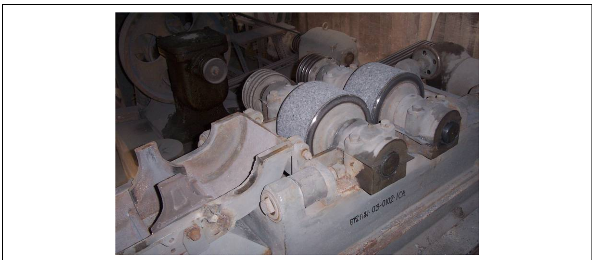
รูป 3.2 ภาพแสดงเครื่อง roll crusher ที่ใช้ในการบดย่อยขนาดแร่
