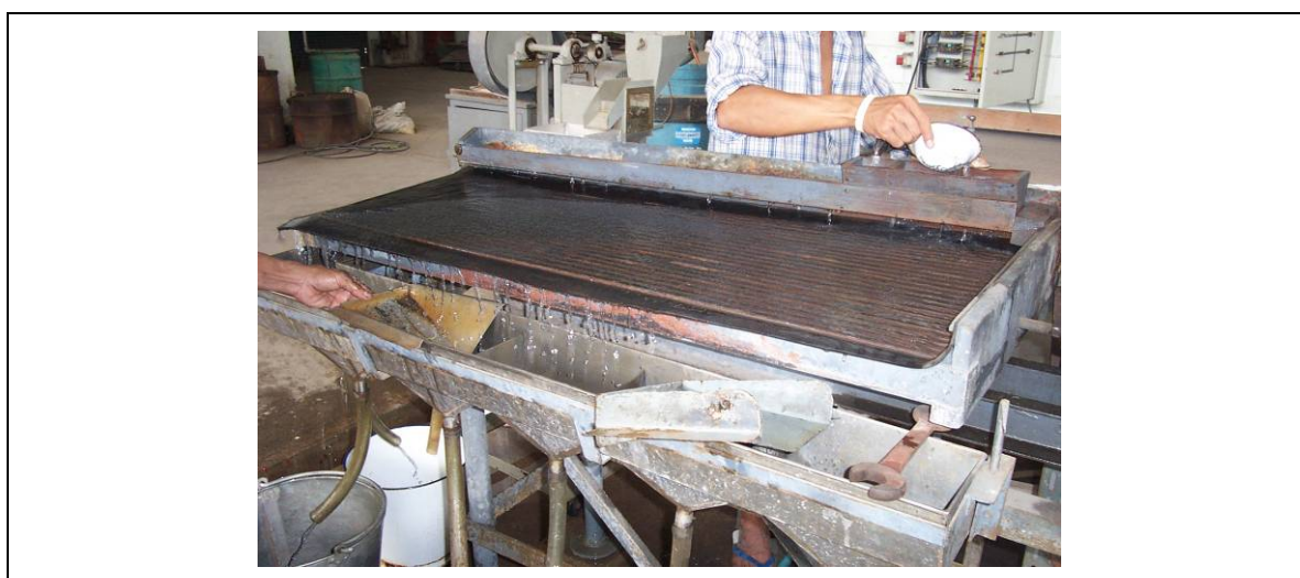
รูป 3.6 การทดลองโต๊ะแยกแร่แบบเปียก (Wet Tabling)
