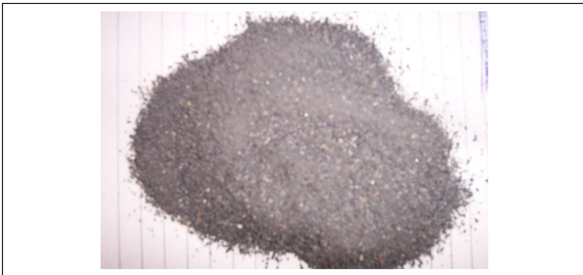
รูป 4.6 ภาพแสดงลักษณะของหางแร่ที่ได้จากการแต่งแร่ด้วยโต๊ะแยกแร่ ที่ขนาดแร่ป้อน -14 เมช
