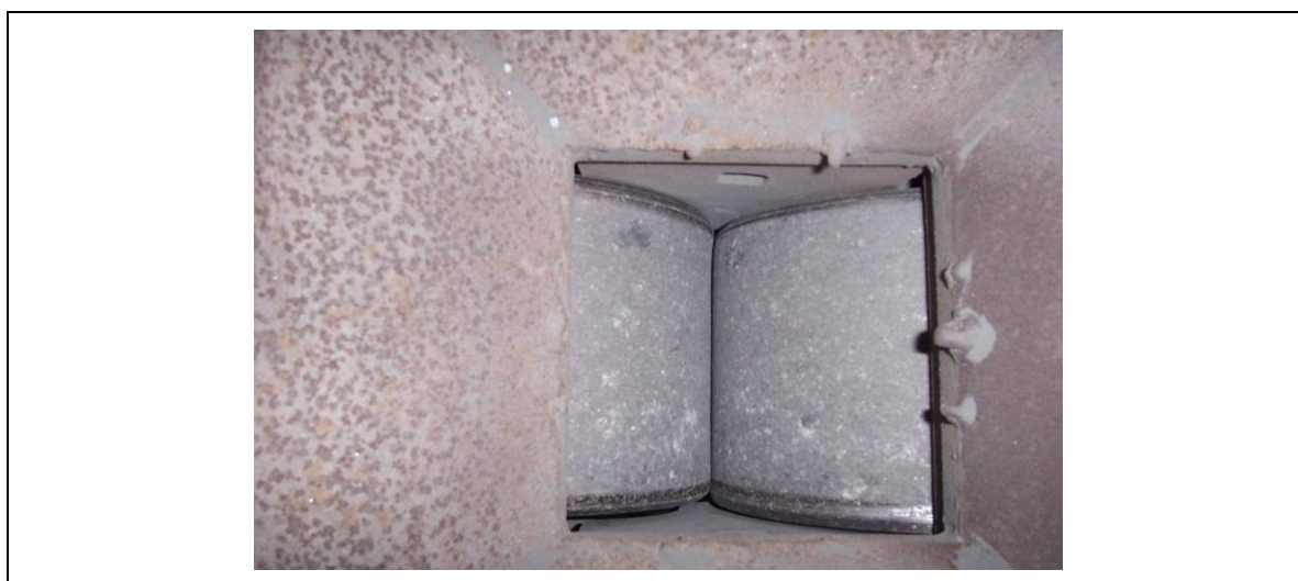
รูป 3.3 ภาพแสดงลักษณะของช่องป้อนแร่ของ roll crusher
