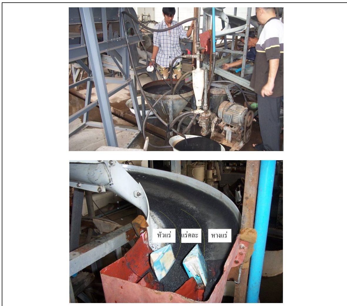
รูป 4.16 ภาพแสดงลักษณะการเดินทางของเม็ดแร่ที่ป้อนเข้าเครื่อง reichert spiral
