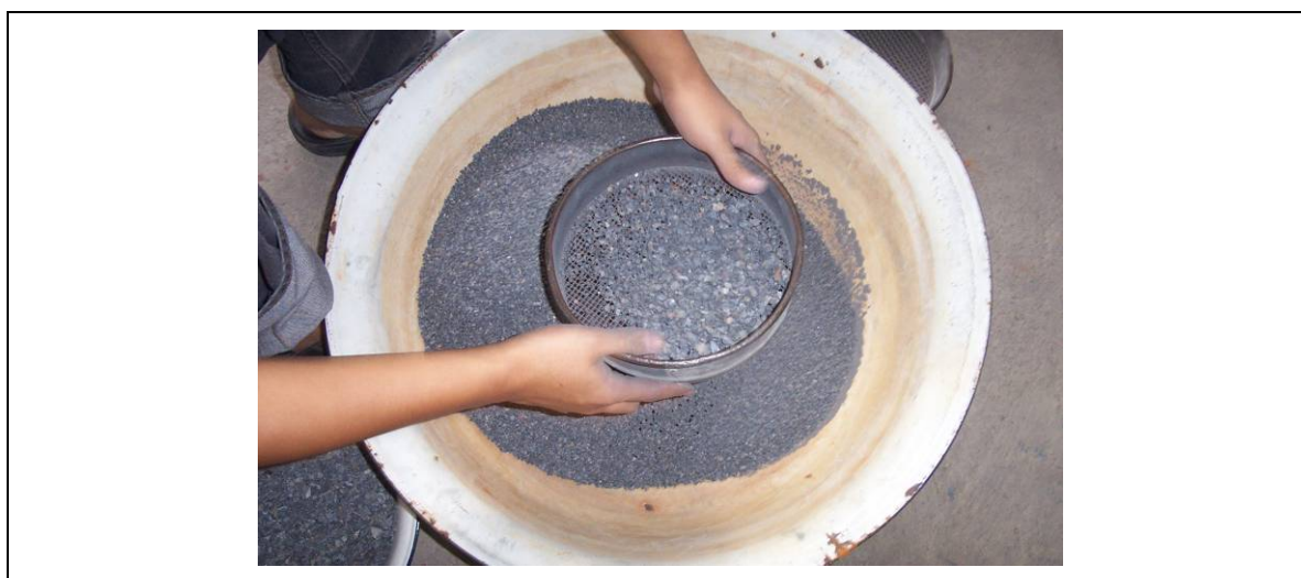
รูป 3.4 ภาพแสดงการคัดขนาดแร่ด้วยตระแกรง
