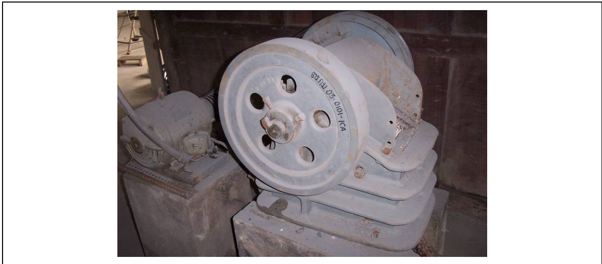
รูป 3.1 ภาพแสดงเครื่อง jaw crusher ที่ใช้ในการบดย่อยขนาดแร่
