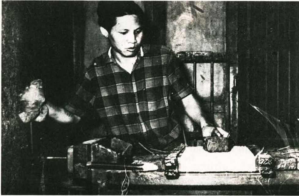
อัดลานทั้งกับให้แน่นอีกครั้งด้วยควง (เครื่องมือที่มีลักษณะเหมือนก๊อปปี้ ใช้อัดใบลานให้แน่น) ก่อนนำเข้าเตาอบ
