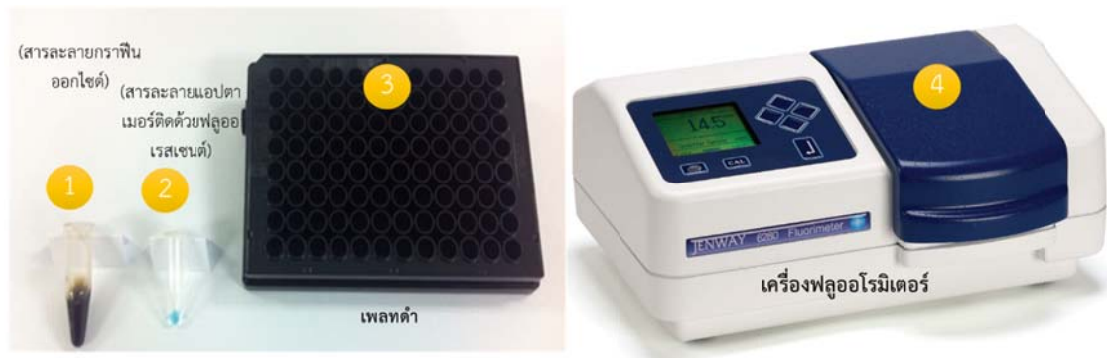
รูปที่ 15: รูปภาพแสดงต้นแบบกรรมวิธีการตรวจวิเคราะห์โลหะเตดอลูมิเนียมที่ใช้ทดสอบในห้องปฏิบัติการในโครงการวิจัยนี้ซึ่งประกอบด้วย (1) สารละลายกราฟีนออกไซด์ (2) สารละลายแอปตาเมอร์ที่ติดด้วยสารฟลูออเรสเซนต์ (3) เพลทสีดำ (4) เครื่องฟลูออโรมิเตอร์
