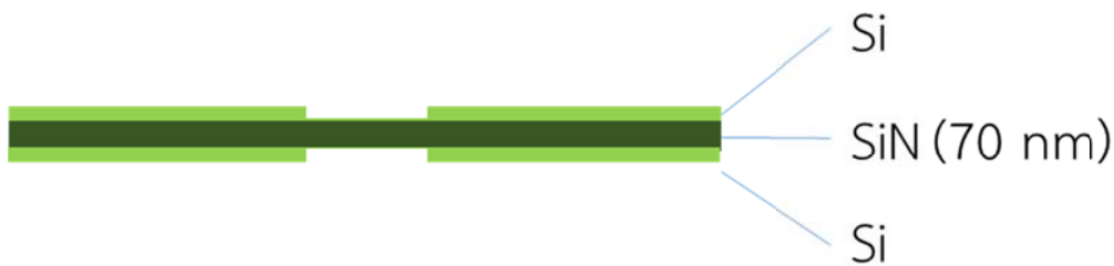
รูปที่ 3: ภาพตัดขวางแสดงโครงสร้างของชิพซิลิคอนและซิลิคอนไนไตรด์เพื่อใช้ในการเจาะนาโนพอร์
