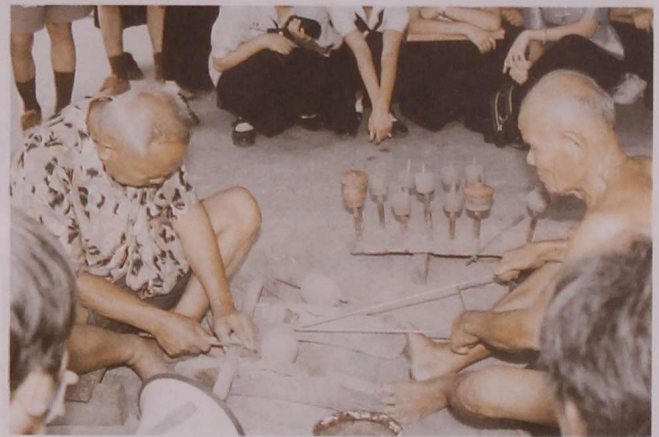
นายทอง ล้อมวงศ์ วิทยากรท้องถิ่นบรรยายขั้นตอนและสาธิตวิธีการหล่อทองเหลืองที่บ้านปะอาว อำเภอเมือง จังหวัดอุบลราชธานี
