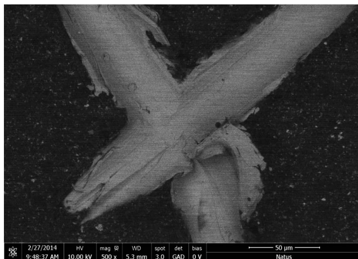
รูปที่ 4.15 ผิวพอลิเมอร์เคลือบที่ผ่านการทดสอบการยึดเกาะบนเข็มของบริษัท B
