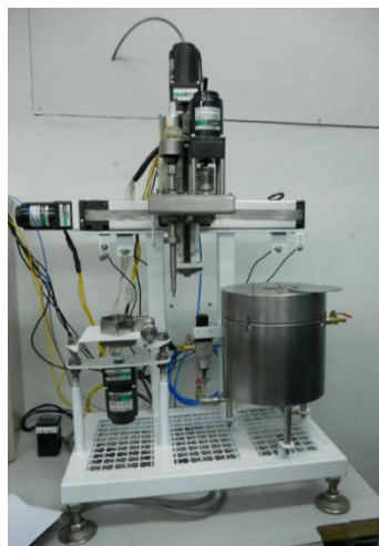
รูปที่ 4.2 เครื่องเคลือบเส้นใยด้วยวิธี Dip-spinning [3]
