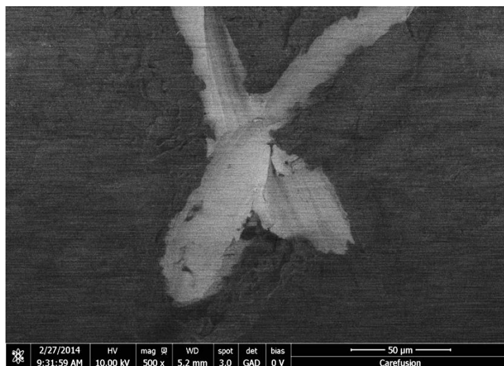
รูปที่ 4.14 ผิวพอลิเมอร์เคลือบที่ผ่านการทดสอบการยึดเกาะบนเข็มของบริษัท A
