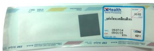
รูปที่ 3.13 บรรจุภัณฑ์ชิ้นงานตัวอย่างผิวพอลิเมอร์เคลือบบนโลหะแผ่น
