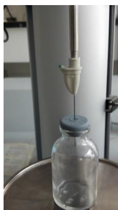
รูปที่ 3.2 Rubber stopper ที่ใช้วัดแรงเสียดทาน
