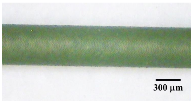
รูปที่ 4.6 ผิวพอลิเมอร์เคลือบของบริษัท B กำลังขยาย 30 เท่า
