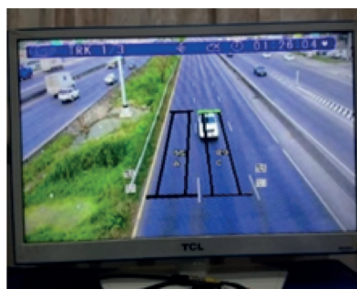
รูปที่ 6 การแปลงภาพเคลื่อนไหวจากกล้องวิดีโอเป็นข้อมูลจราจร โดยเครื่องมือ Autoscope
