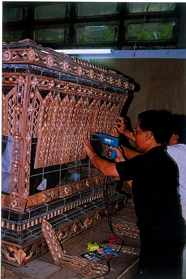
การผูกลายกับโครงตาข่าย โดยการเจาะรูที่ดอกลาย ใช้ผูกด้ายลวดมัดกับไม้ด้านในฐาน
