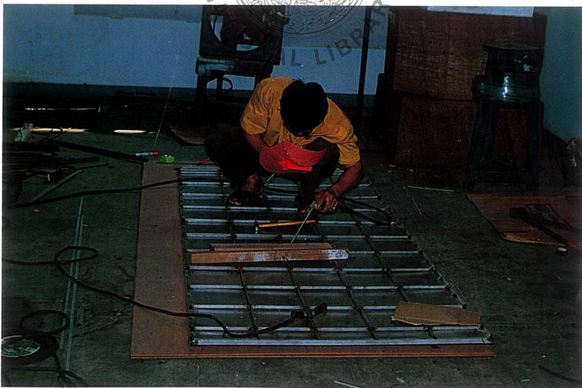
การเชื่อมเหล็กโลหะลงในไร้สนิมขององค์พระโกศ
