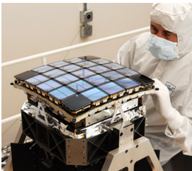
รูปที่ 8.2: อุปกรณ์ตรวจวัดของดาวเทียม Kepler ประกอบด้วย CCD จำนวน 42 ชิ้น CCD แต่ละชิ้นมีขนาด 50x25 mm และมีความละเอียด 2200x1024 pixels (ภาพโดย โครงการกล้องโทรทรรศน์อวกาศ Kepler)
