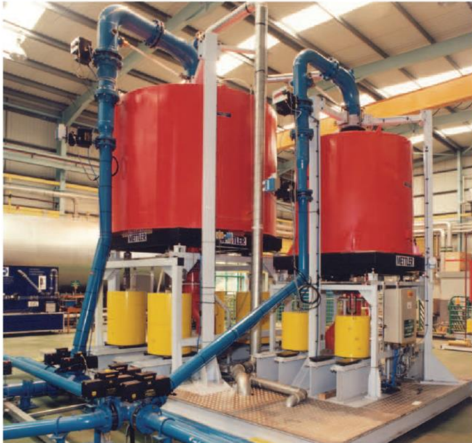
รูปที่ 9-16 ภาพขณะบรรจุของเหลวปิโตรเลียมพร้อมเครื่องชั่งในการสอบเทียบแบบ Gravimetric Method วิธีจัดเก็บของเหลว แบบ Standing start and stop method
