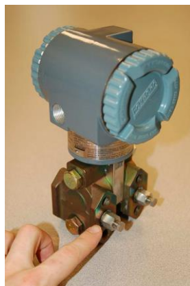
รูปที่ 3-20 เครื่องวัดความดันที่ใช้ silicon strain gauge ใช้วัดผลต่างความดันระหว่าง 2 จุด (Foxboro model IDP10; Differential Pressure Transmitter)
