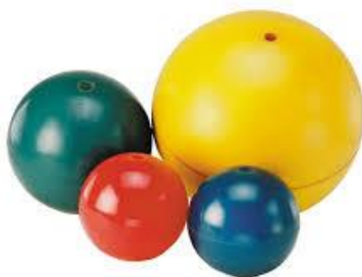
รูปที่ 9-44 ลูกบอลใน Conventional pipe prover ที่ไปดัน Detector และแบ่งของเหลว
