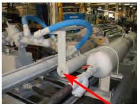
รูปที่ 8-12 เมื่อตัวระบุตำแหน่ง(flag) ของตัวกวาดตัดผ่านระหว่าง Optical Switch
