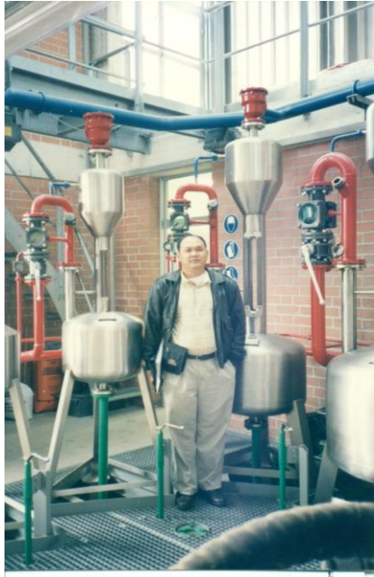
รูปที่ 9-23 ถังตวงแบบมาตรา “แบบรับ” เพื่อรับปริมาตรของเหลวผลิตภัณฑ์ปิโตรเลียมที่ผ่านการวัดของมาตรวัดปริมาตรของเหลว (ซ้ายมือ) ส่วนถังตวงแบบมาตราใช้รับน้ำจากมาตรวัดน้ำประปา (ขวามือ)
