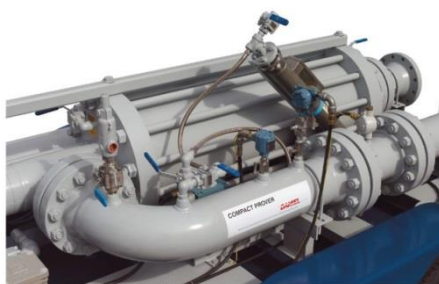
รูปที่ 8-21 สอบเทียบท่อทดสอบความจุขนาดเล็กด้วยวิธี Master Flowmeter Method
