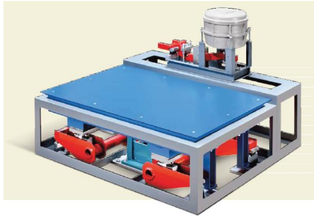
รูปที่ 9-20 เครื่องชั่ง Gyroscopic สำหรับสอบเทียบมาตรวัดปริมาตรของเหลวด้วยวิธีชั่งน้ำหนัก; Max = 40,000 \text{ kg} , d = 100 \text{ g} , n = 300,000 (WÖHWA Waagenbau GmbH)
