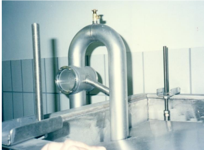
รูปที่ 9-9 อุปกรณ์ที่เรียกว่า “weir” หรือ เรียกว่า “transfer point”
