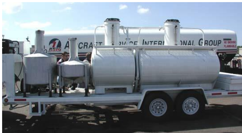
รูปที่ 7-101 ถังตวงแบบมาตราพิกัดกำลังสูงบนรถโมบาย
