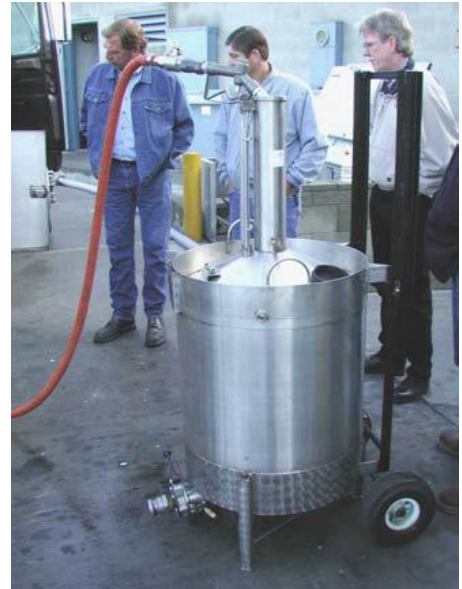
รูปที่ 6-9 ท่อเติมของเหลวที่ปลายท่อจุ่มอยู่บริเวณก้นเครื่องตวงแบบมาตรา (Submerged Fill Pipe)
