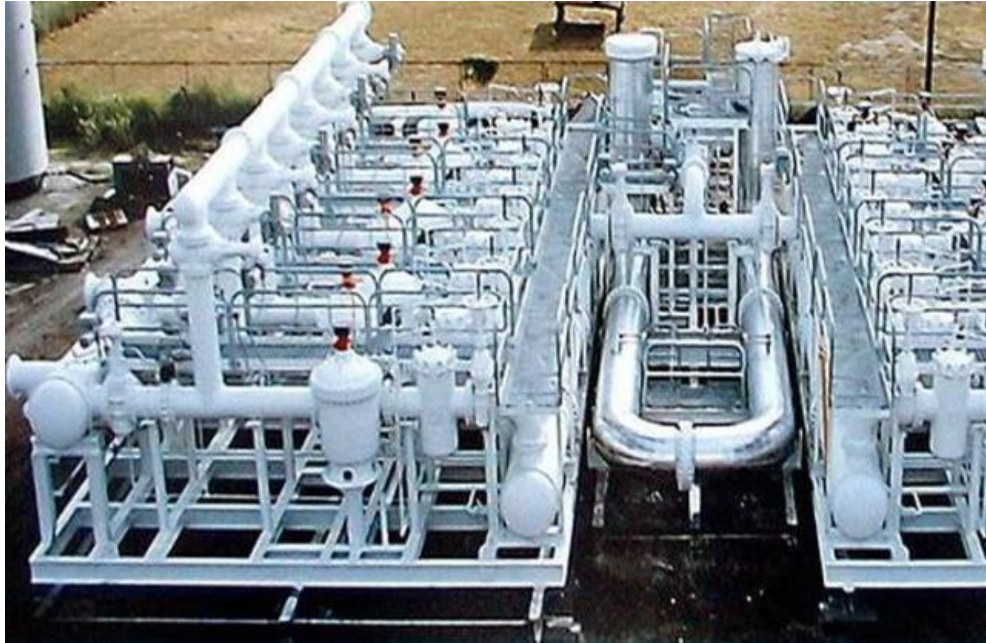
รูปที่ 9-26 Metering System โดยมี Conventional Pipe Prove เป็นแบบมาตรฐานสอบเทียบมาตรวัด PD
