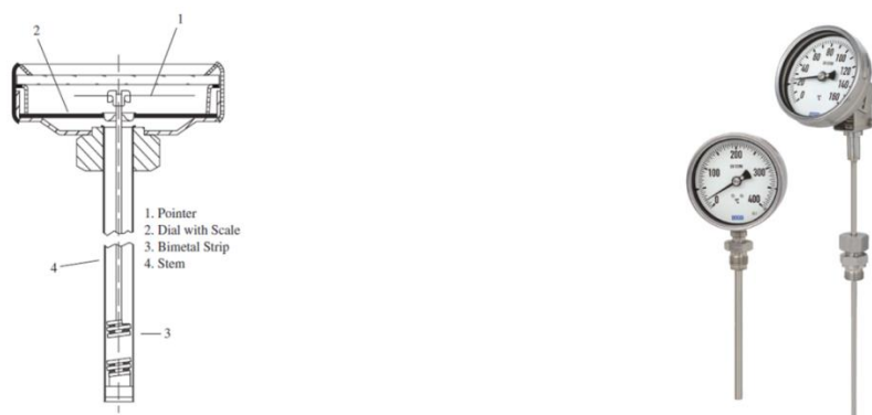
รูปที่ 2-34 รูปร่างโดยทั่วไปของเครื่องวัดอุณหภูมิชนิด Bimetallic Thermometer ประกอบด้วย Dual Helical Bimetal Coil (WIKA Instrument Corporation)
