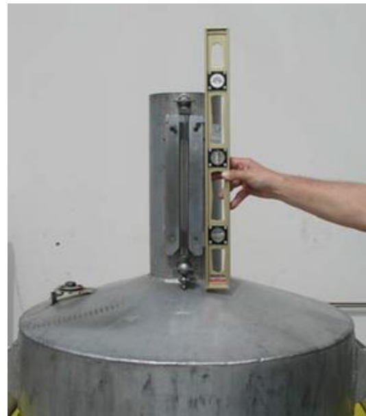
รูปที่ 6-2 ที่วัดระดับของเหลวของเครื่องตวงแบบมาตราخذึงตวงทำด้วยโลหะ
