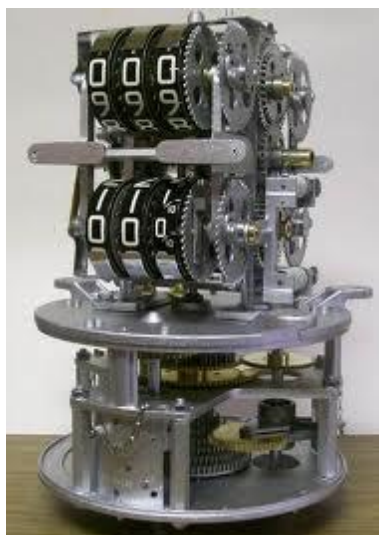
รูปที่ 7-7 ตัวปรับความเที่ยงตรงแบบ Change-gear and Cone-gear Calibrators
