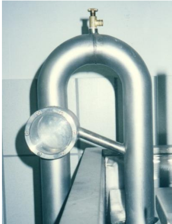
รูปที่ 6-11 “ระดับน้ำเริ่มต้น-สิ้นสุดอ้างอิง” หรือ “Sight Glass with Weir” (OIML R120)
