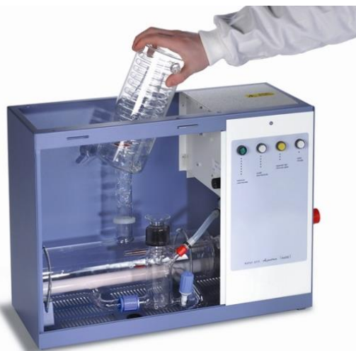
รูปที่ 5-11 เครื่องทำน้ำกลั่น 2 ครั้ง
