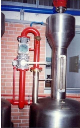
รูปที่ 9-9 อุปกรณ์ที่เรียกว่า “weir” หรือ เรียกว่า “transfer point”
