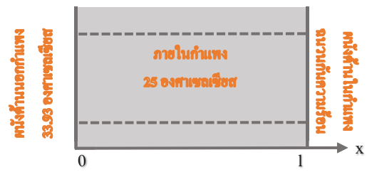
รูปที่ 4 ค่าอุณหภูมิเริ่มต้นภายในกำแพงและค่าอุณหภูมิที่ขอบกำแพงด้านนอก
