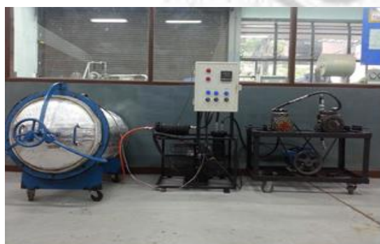
ภาพที่ 2 เครื่องอบแห้งอินฟราเรดระบบสุญญากาศ กรณีศึกษาการอบเนื้อขนุน
