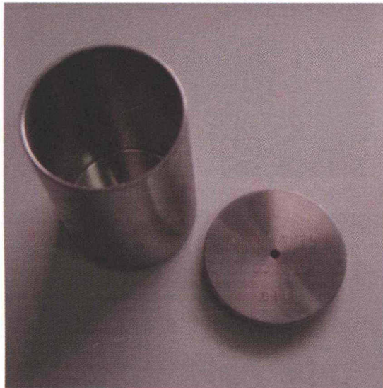
ภาพที่ 14 ถ้วยสเตนเลสเพื่อหาความหนาแน่นของน้ำเคลือบ
