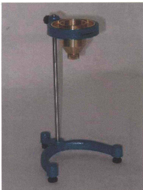
ภาพที่ 15 ถ้วยฟอร์ตหมายเลข 2 (Ford Cup No.2) เพื่อวัดอัตราการไหลตัวของน้ำเคลือบ
