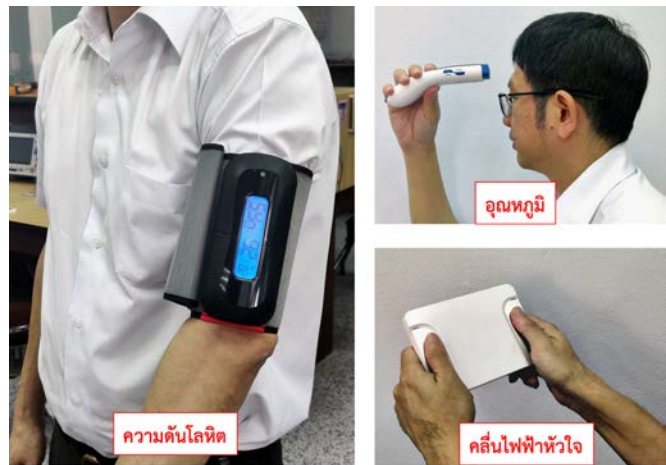
ภาพที่ 4 ตัวอย่างการใช้งานอุปกรณ์วัดสัญญาณชีพ ที่มา : อภิวัฒน์ เล็กอุทัย ถ่ายเมื่อ กันยายน 2563
