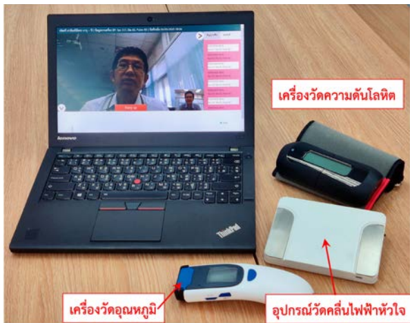
ภาพที่ 3 ภาพถ่ายอุปกรณ์วัดสัญญาณชีพที่ใช้ในระบบวัดสัญญาณชีพแบบหลายพารามิเตอร์ ที่มา : อภิวัฒน์ เล็กอุทัย ถ่ายเมื่อ กันยายน 2563
