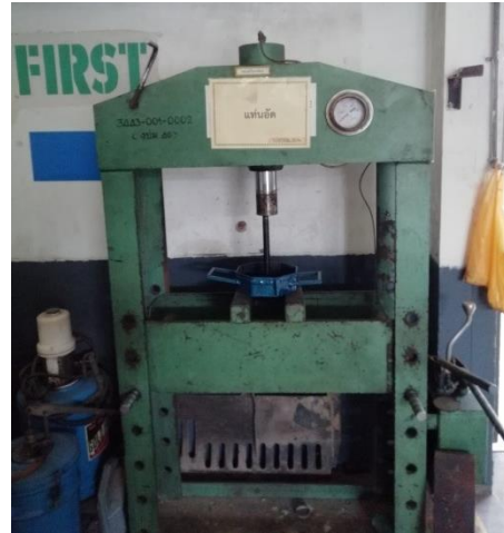
รูปที่ 14 อัดบล็อกแม่พิมพ์พลาสติกด้วยแท่นอัดไฮดรอลิกส์
