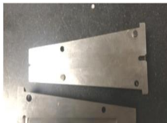
รูปที่ 3 ASTM D790-07 molded material flex bar mold
