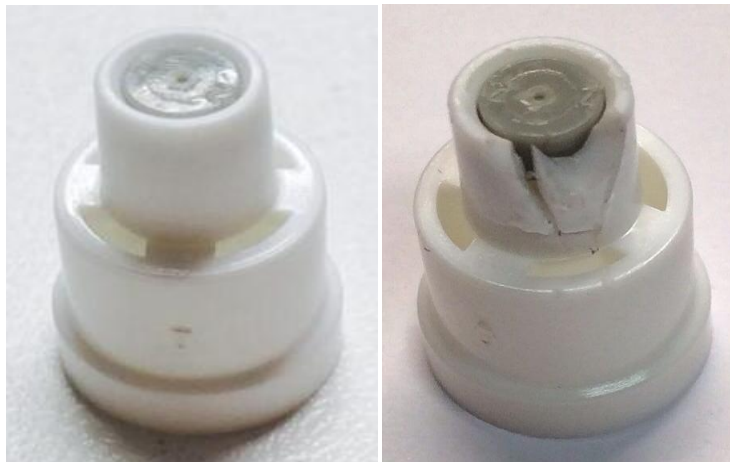
ภาพที่ 3.2 หัวฉีดวัคซีนทางการค้า: สภาพปกติ (ซ้าย) และหลังทำการศึกษาทดลองทางกายภาพ (ขวา)
