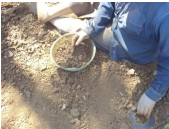
ภาพที่ 2 การใช้แม่เหล็กดูดหาก่อนหินที่มีแร่เหล็ก
