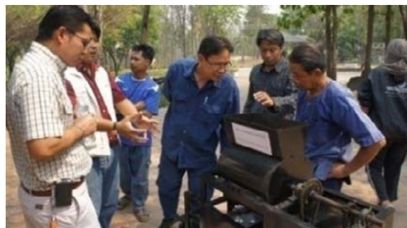
ภาพที่ 8 การทดสอบสมรรถนะของเครื่องนวดส่วนผสมดินกับผงแร่เหล็กน้ำพี้
