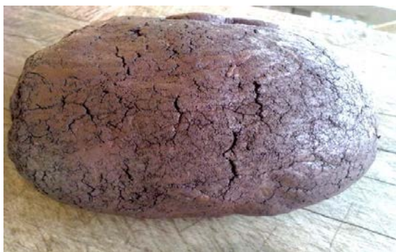
ภาพที่ 11 ลักษณะของส่วนผสมระหว่างดินเหนียวกับผงแร่เหล็กน้ำพี้
