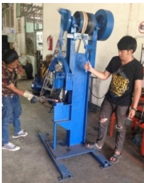
ภาพที่ 9 การทดสอบสมรรถนะของเครื่องตีดาบและมิดเหล็กน้ำพี้
