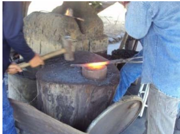
ภาพที่ 12 การใช้แรงงานตีดาบและมิดจากเหล็กน้ำพี้
