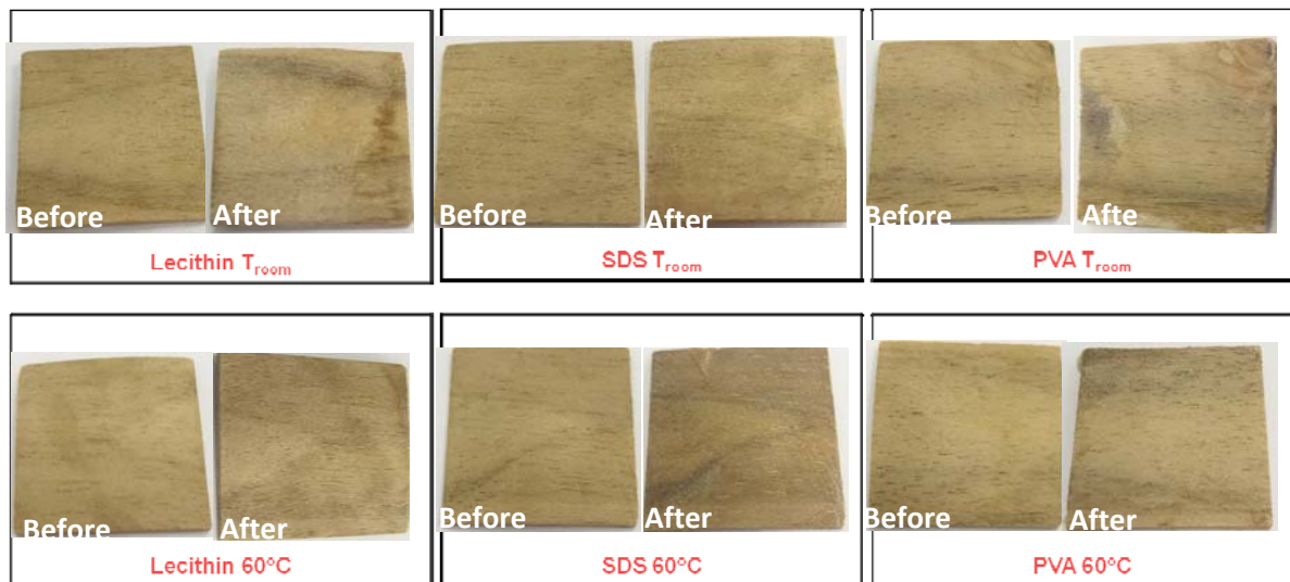
รูปที่ 2 แสดงสีของเนื้อไม้ที่ผ่านกรรมวิธีปรับปรุงคุณสมบัติจากการเคลือบของอนุภาคระดับนาโนของ AKD
