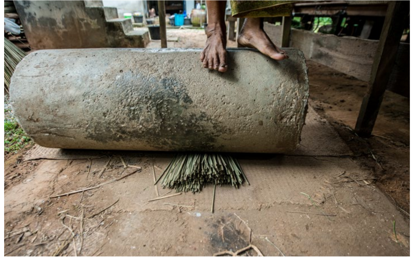
ขั้นตอนการรีดกระจูดให้เรียบ ก่อนนำไปซुบโคลนแล้วตากแห้ง เพื่อนำไปจักสานต่อไป Krajood need to be flattened and sun dried before being used.
