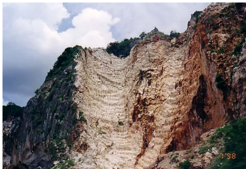
รูปที่ 6.3.1 การห้อยโหนเจาะในการระเบิดหินตาม พ.ร.บ. ที่ดิน
