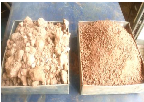
รูปที่ 13 การเปรียบเทียบดิน (ก) ก่อนเข้าเครื่องย่อยดิน และ (ข) หลังเข้าเครื่องย่อยดิน
