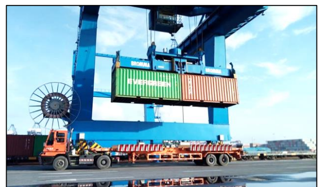
ด้านซ้ายและขวาของ RMG มี Track สำหรับบรรทุกทุกอีกข้างละ 4 ช่อง
