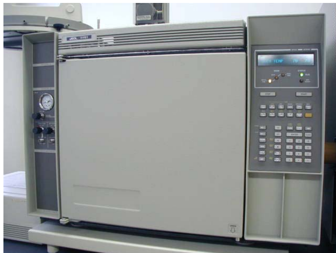
รูปที่ 7 แสดงเครื่อง GC ชนิดที่มีตัวตรวจวัดชนิด ECD และ NPD สามารถตรวจหาสารเคมีกลุ่มออร์กาโนคลอรีนและออร์กาโนฟอสเฟตได้
