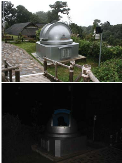
สถาบันฯ ได้ติดตั้งกล้องโทรทรรศน์ขนาดเส้นผ่านศูนย์กลาง 14 นิ้ว เพื่อทำการวัดค่าทัศนวิสัยทางดาราศาสตร์ (Astronomical Seeing Measurement) และค่าความสว่างของท้องฟ้า บริเวณทบวยฟ้าห้วยยอดดอยอุทยานแห่งชาติดอยอินทนนท์
