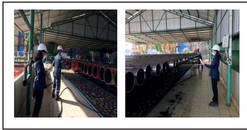
ภาพที่ 3 การตรวจวัดเสียงในพื้นที่การทำงาน เป่าลมด้านหัว-ด้านท้าย
