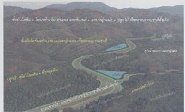
สภาพพื้นที่ต้นน้ำเกิดการชะล้างพังทลาย และการออกแบบระบบอนุรักษ์ดินและน้ำเพื่อพื้นที่
