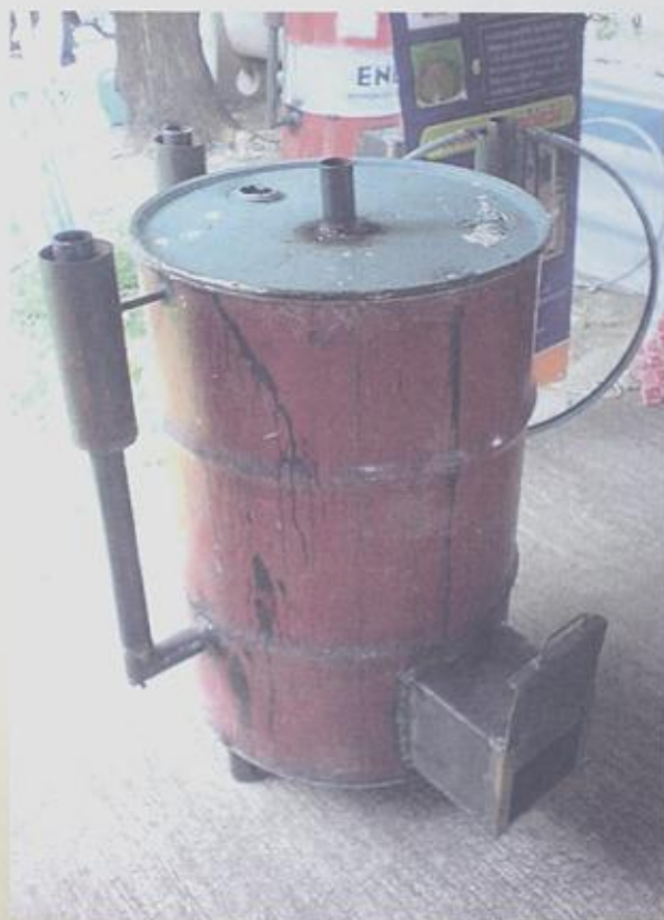
เตาเผาถ่านเคลื่อนที่มีระบบดักน้ำส้มควันไม้ กรมพัฒนาพลังงานทดแทนและอนุรักษ์พลังงาน
