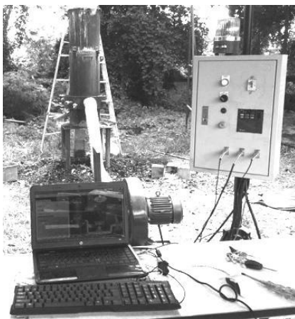
ภาพที่ 6 ชุดระบบควบคุมอัตโนมัติสำหรับเตาถลุง สินแร่เหล็กน้ำพี้แบบควิปโลา
