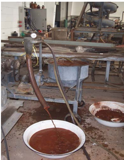
รูป 2.4 ขณะทำการคัดขนาดด้วยไฮโดรไซโคลน
