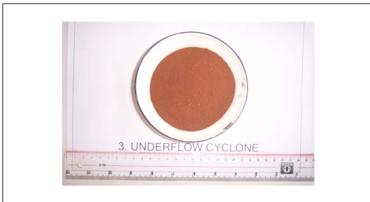
รูป 3.4 ตัวอย่าง HM-UF ผ่านไฮโดรไซโคลนส่วนที่ออกจาก underflow
