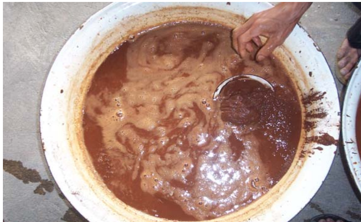
รูป 2.1 นำแร่มาแช่น้ำและกวนทิ้งไว้เพื่อละลายเอาดิน(Slime)ออก
