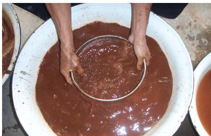
รูป 2.2 นำแรมมาแช่น้ำและกวนทิ้งไว้เพื่อละลายเอาดิน(Slime)ออก ทำการร่อนเปียกด้วยตะแกรงเพื่อคัดเอาเม็ดแรมขนาด+20mesh
