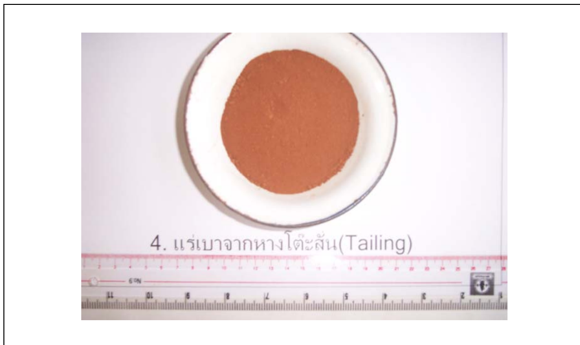
รูป 3.5 ตัวอย่าง HM-TL แร่ออกจากโตะแยกแร่
