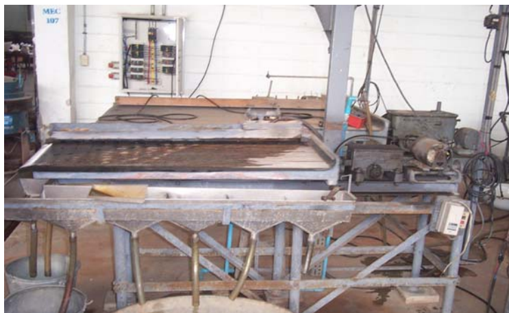
รูป 2.5 ขณะทำการัดขนาดด้วยโต๊ะแยกแร่
