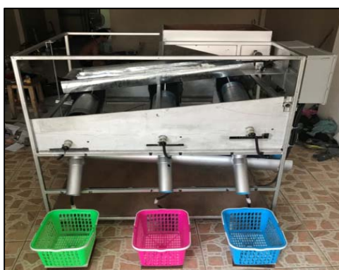
รูปที่ 25 เครื่องคัดแยกขนาดลูกมะนาว
