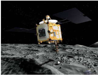
รูปที่ 73 ภาพจินตนาการแสดงยานฮายาบุสะ ขณะกำลังใช้อุปกรณ์เพื่อเก็บตัวอย่างจากดาวเคราะห์น้อยอิโตกาว่า พร้อมแสดงยานลำลูกมินิเอร์วา หากลงจอดสำเร็จ [Credit ภาพ: JAXA]
