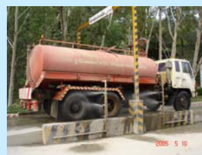
ลานลำเลียงที่มีระบบฉีดน้ำล้าง อัตโนมัติ และการระบายน้ำลง สู่บ่อตกตะกอน
